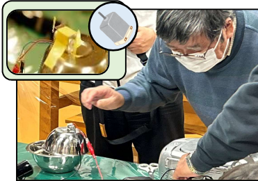
モーターとイヤホンジャックを接続すると、モーターが音楽を奏でる
