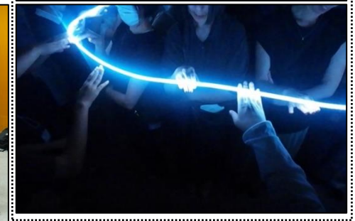
ホースを使った酸素と水素の爆鳴気実験 (上図:1回目 下図:2回目)
