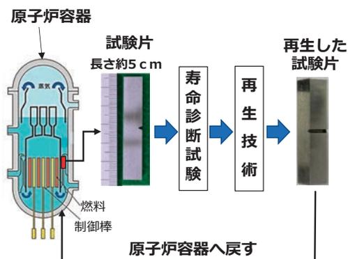
原子炉容器の寿命を確認するため、容器と同じ材料で作った「試験片」が原子炉に入っています。この「試験片」を定期的に取り出して原子炉に問題ないことを確認してあいます。
