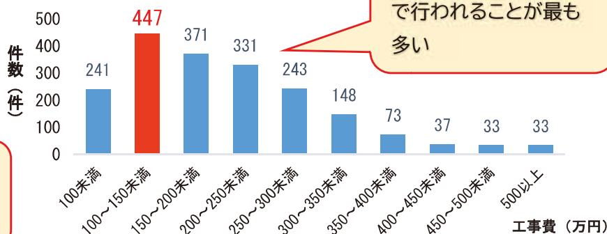
木造2階建ての耐震改修工事の分布
