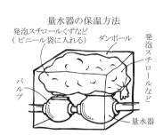
◇量水器は、ビニール袋に 発泡スチロールやぼろ布 を詰めたものを量水器の 箱の中に入れ、さらに段 ボールなどを載せて保温 してください。
