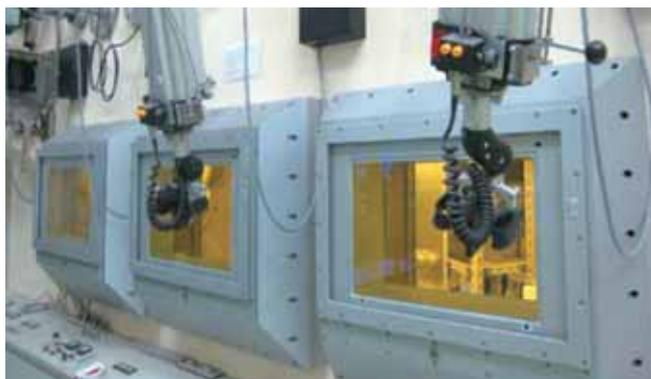
$\alpha$ 線に加えて $\gamma$ 線も放射し法的規制が極めて厳しい超ウラン元素(アクチノイド元素)のNp, Pu, Amを取り扱える施設である。基礎研究用設備としては、他には日本原子力研究開発機構先端基礎研究センター、米国ロスアラモス研究所、欧州超ウラン元素研究所などがあるのみである。前面にはマニピュレータ、背面にはグローブポートが配され、電気炉が設置されており、Np化合物の単結晶育成が行える。
