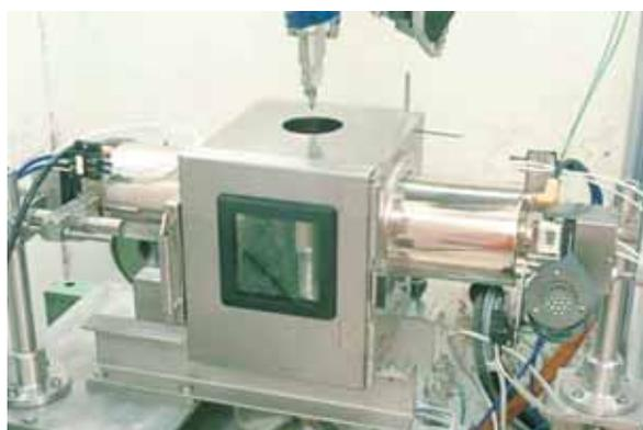
標準サイズ（10mm×10mm×55mm）から世界で最も微小な寸法（1mm×1mm×20mm）のシャルピー試験片について計装化衝撃試験（速度：5m/s）を行い、延性・脆性遷移温度を評価する（試験温度：77K～1000K）。
