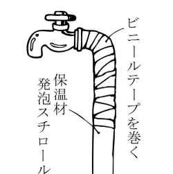
◇水抜き装置の付いていない屋外用の立上がり管は、不凍水栓(立上がり管の中の水を抜いて凍結を防ぐ)に取り替えるようお勧めします。
