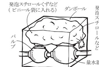
◇量水器は、ビニール袋に発泡スチロールやぼろ布を詰めたものを量水器の箱の中に入れ、さらに段ボールなどを載せて保温してください。
