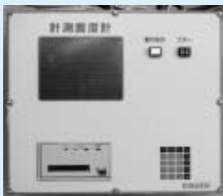
大洗町消防本部に設置されている計測震度計
