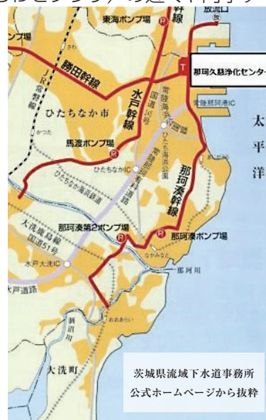
「那珂湊幹線」が、大洗町下水道から出た汚水の通り道です。
