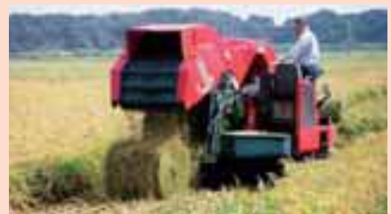
稲・葉・茎全部を裁断・圧縮してロール状にします
