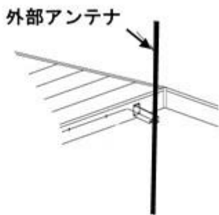
外部アンテナ取付例（長さ2m）
